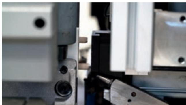
Gruppo per la gestione dell'inserimento di colla e spina con sistema brevettato con CU a richiamo dell'aggregato di lavoro.
