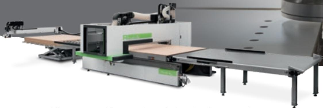
Rover A FT è il nuovo centro di lavoro per lavorazioni Nesting altamente performante. Compatto e prestazionale con struttura Gantry, Rover A FT offre tecnologia di alta gamma garantendo massima precisione in ogni lavorazione.
