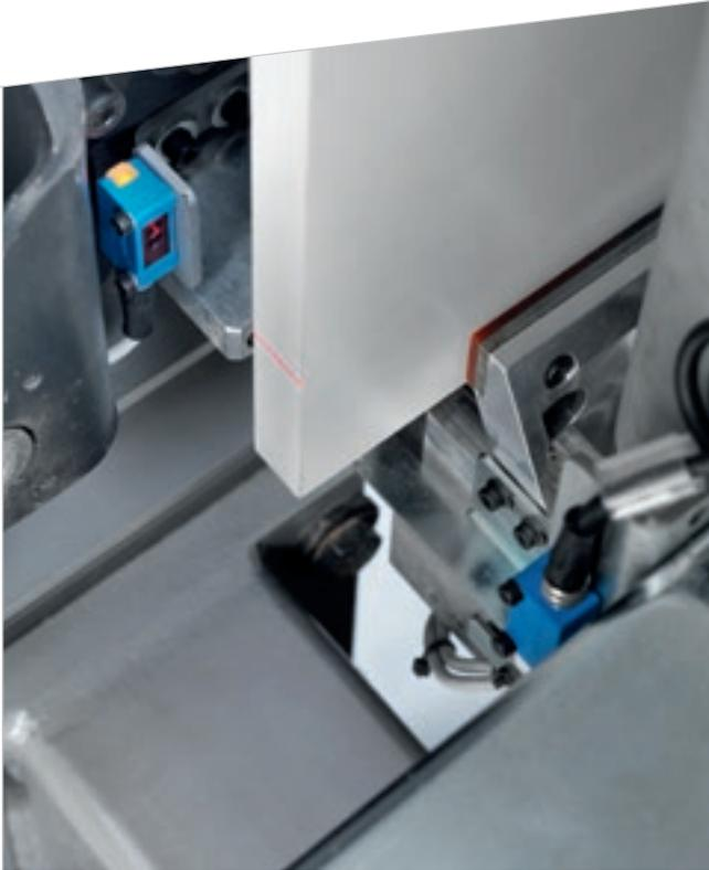
Sistema di **lettura laser** per rilevare l'origine e la coda del pannello che permette alla macchina di compensare gli errori dimensionali correggendo le quote X del pannello.
